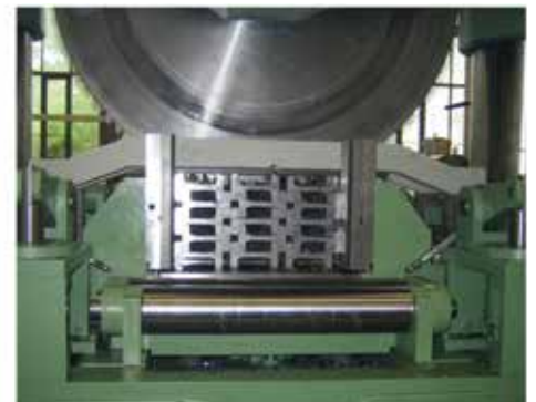
Profilbündelschnitt Hartmetallbestücktes Kreissägeblatt \varnothing 1150 mm H-Profile im Bündel
