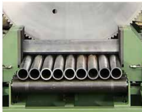
Rohrlagenschnitt Hartmetallbestücktes Kreissägeblatt \varnothing 1120 mm Rohre \varnothing 70 mm
