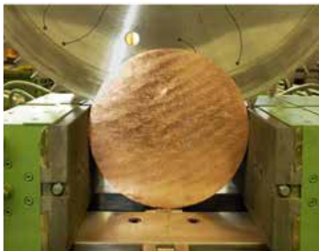
Blockschnitt Hartmetallbestücktes Kreissägeblatt \varnothing 1150 mm Kupferbolzen \varnothing 425 mm
